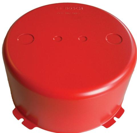
在发生火灾时，安装扬声器的天花板孔隙会使火焰在整个建筑特内蔓延。为了防止火苗通过扬声器进入孔隙，天花扬声器可以安装钢制防火罩。这一可选防火罩可以通过随附的四颗自攻螺丝安装在扬声器组件上。防火罩设有用于安装两个垫圈(随附)和两个电缆密封塞(PG 13)的开孔。
